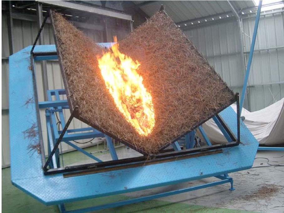
Figura 5. Estrutura para estudo laboratorial do comportamento eruptivo do fogo existente no Laboratório de Estudos sobre Incêndios Florestais.
